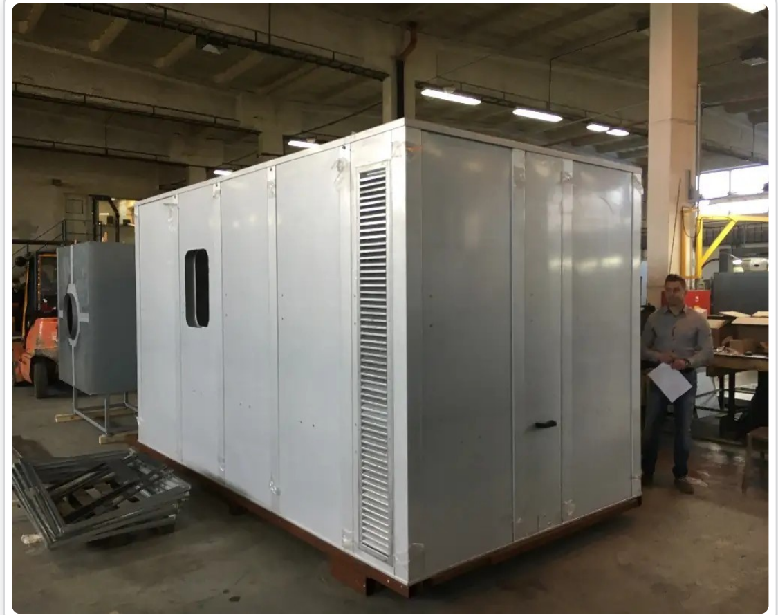
Große modulare Schalldämmhaube aus Metall für eine industrielle Anlage in einer Fertigungshalle
