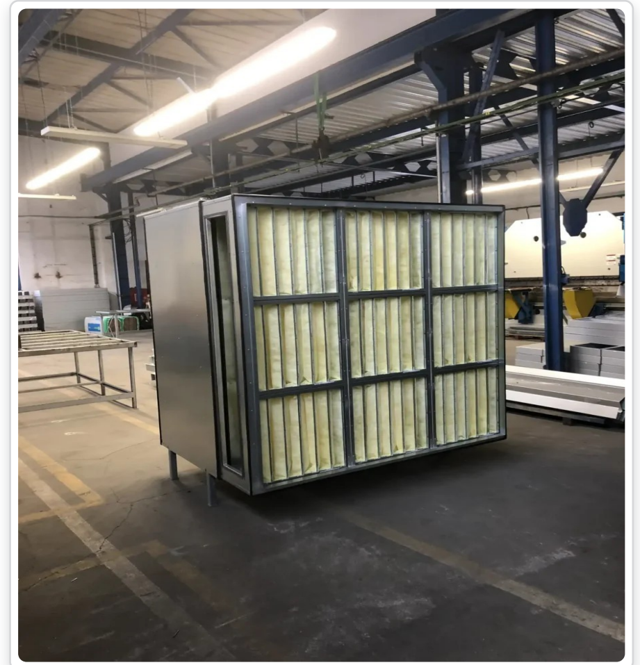
Unidad filtrante multietapa para un silenciador de admisión industrial
