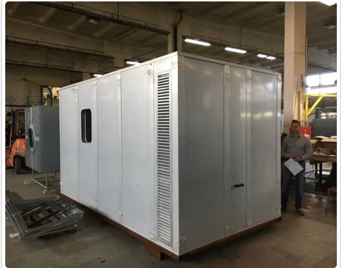
Gran cabina acústica modular metálica para una instalación industrial en una nave de producción
